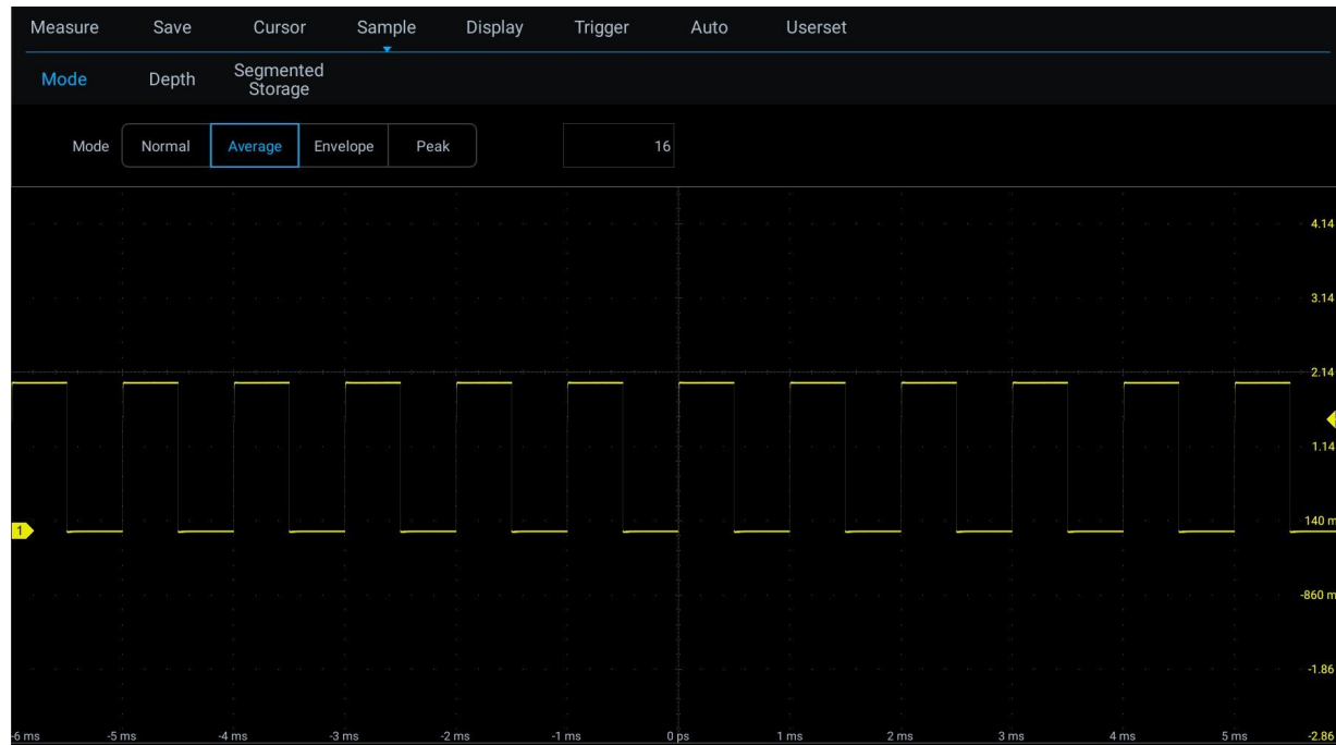
Abbildung 11-7 Wellenform nach Auswahl des Durchschnitts-Abtastmodus mit der Durchschnittsanzahl 16
