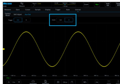
Abbildung 4 Wählen Sie in der „UserSet“-Oberfläche des Oszilloskops „Aux Out – Clock In“
