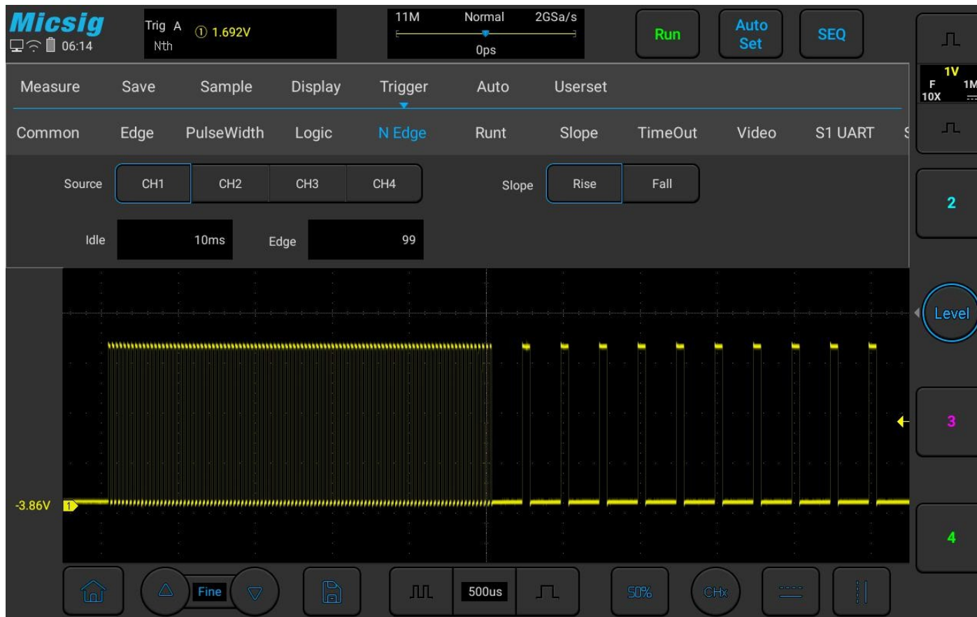
Abbildung 5-23 Menü „N-te Flanke“
