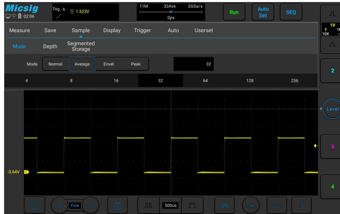
Abbildung 10-7 Wellenform nach Auswahl des Durchschnitts-Abtastmodus mit der Durchschnittsanzahl 32
