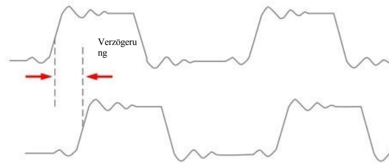
Abbildung 6-5 Schematische Darstellung der Verzögerungsmessung
