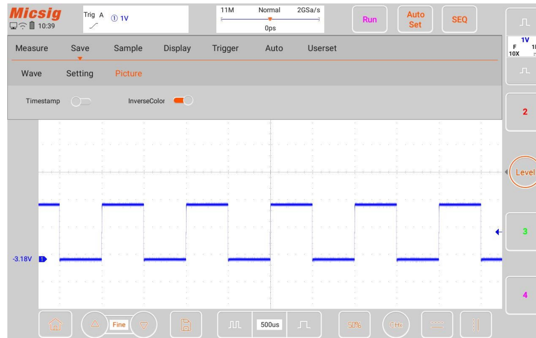
Abbildung 7-2 Zeitstempel und Farbinversion
