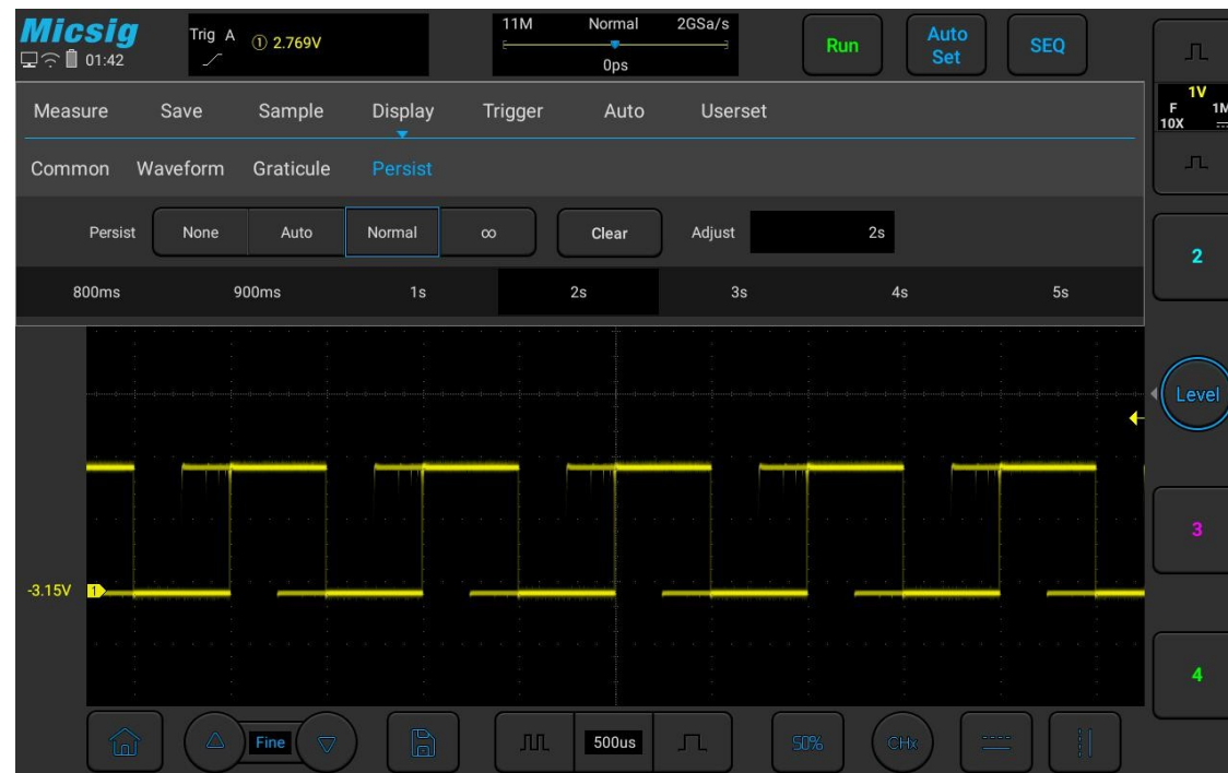
Abbildung 9-4 Einstellung der Persistenzzeit
