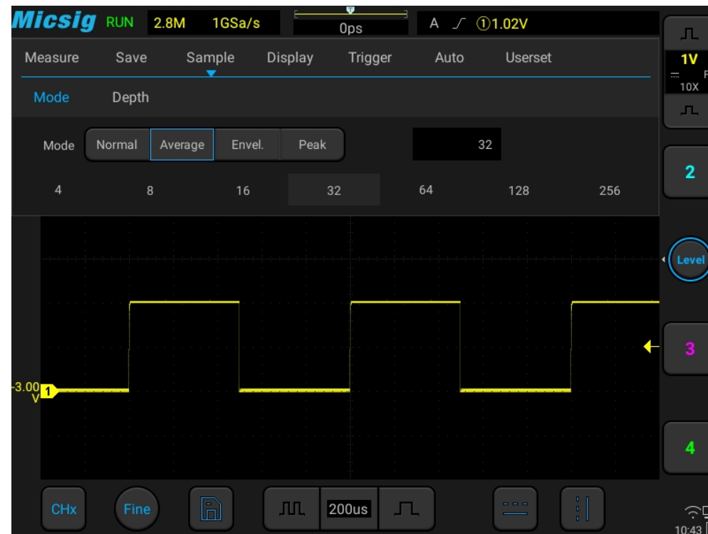
Abbildung 11-7 Wellenform nach Auswahl des durchschnittlichen Abtastmodus mit dem Durchschnittswert 32
