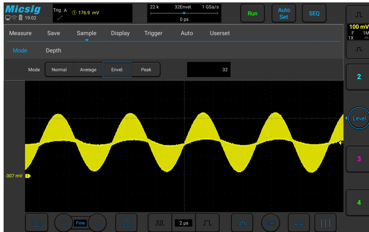
Abbildung 11-8 AM-Signal im Hüllkurven-Abtastmodus (32)
