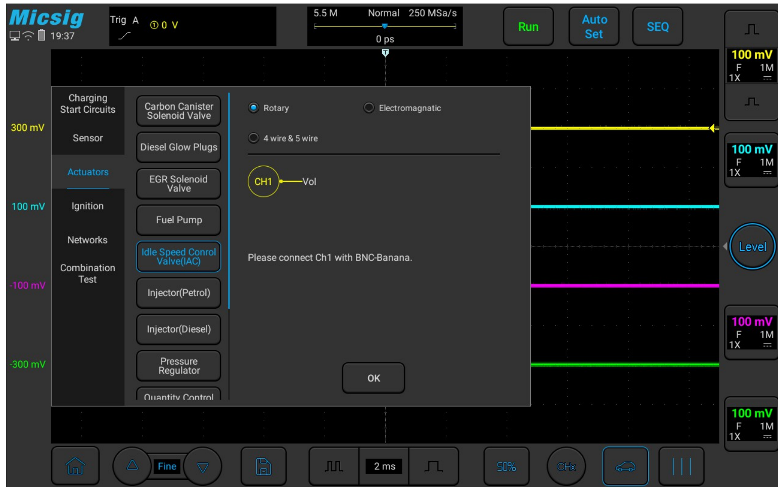
Abbildung 3-31 Test des Leerlaufdrehzahlregelventils
