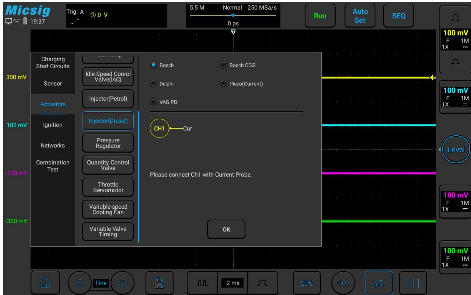
Abbildung 3-33 Test des Einspritzventils (Dieselmotor)
