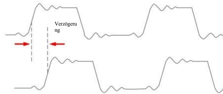
Abbildung 7-5 Schematische Darstellung der Verzögerungsmessung
