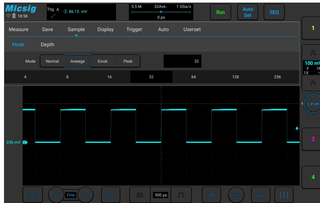
Abbildung 11-7 Wellenform nach Auswahl des durchschnittlichen Abtastmodus mit dem Durchschnittswert 32
