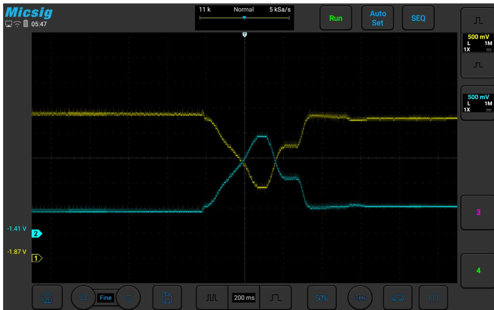
Abbildung 3-25 Diagramm des Drosselklappensensors
