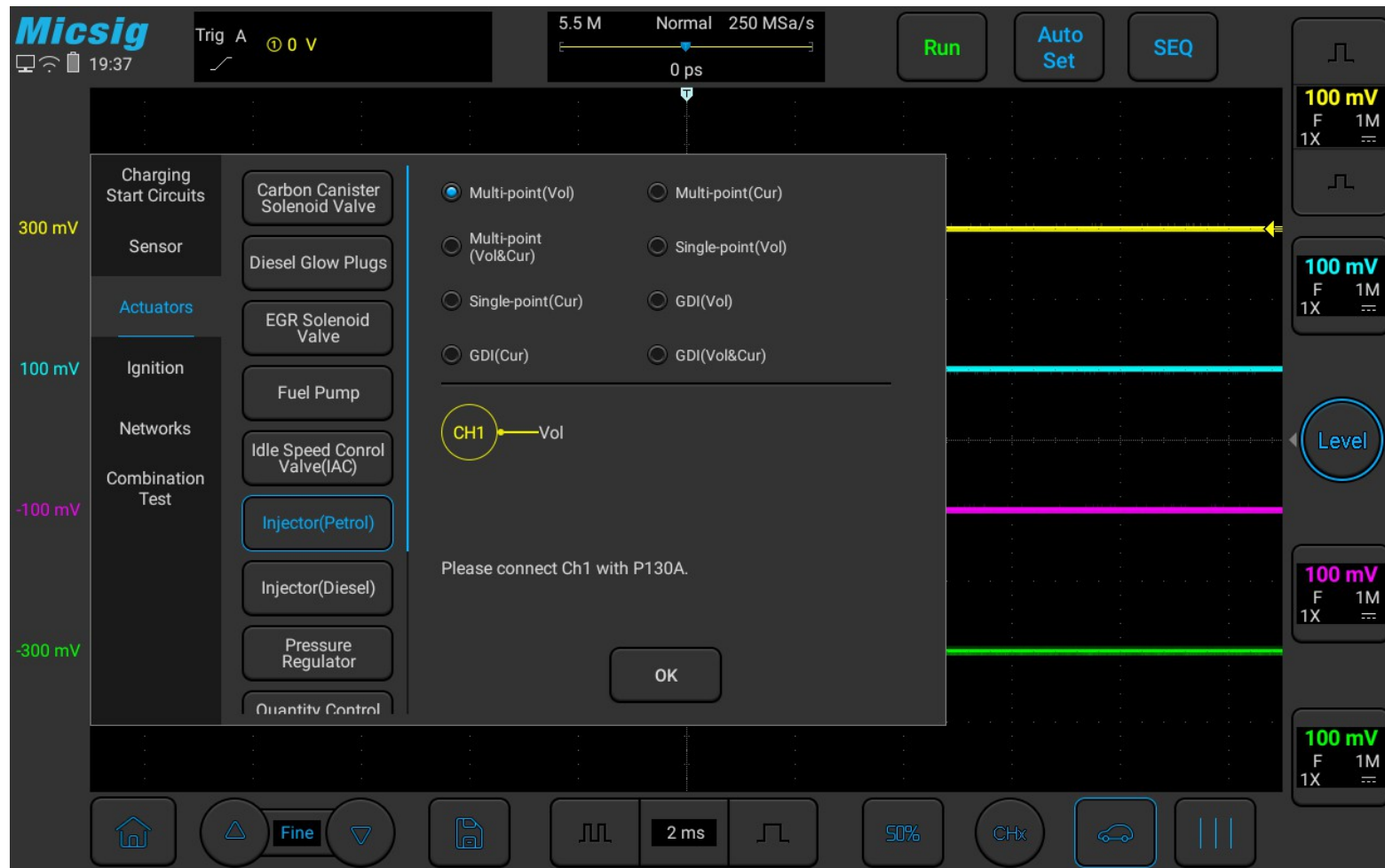
Abbildung 3-32 Test des Einspritzventils (Benzin)
